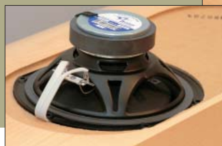
165-mm woofer wygląda niepozornie. Frez do mocowania maskownicy z powodzeniem pomieściłby dwa takie woofery
