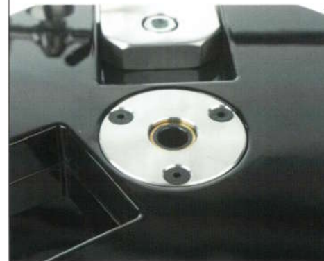
Im Inneren der fest mit der Laufwerksbasis verschraubten Lagerhülse erkennt man die durch Verguss mit der Achse entstandene horizontale Führung
