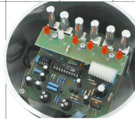
Digitalechnik macht's möglich: Die elektronische Motorsteuerung verbessert die klanglichen Eigenschaften des Antriebs deutlich
