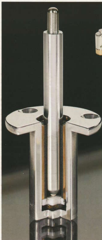
Lagerarbeit: Die Achse steckt in einer per Verguss hergestellten Kunststoffbuchse, vertikal fängt eine Keramikugel die Kräfte auf
