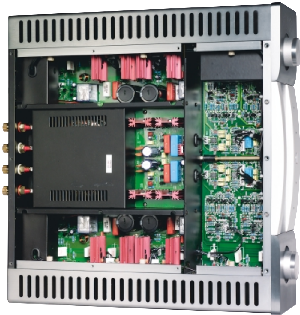
Oben: Vollsymmetrische Endstufe? Kein Problem! Der Vincent SV-233 verfügt über eine echte Brückenkonfiguration, hier die Treiberstufe eines Kanals. Links: Der Hammer schlechthin: So viel Verstärker für 2000 Mark gab's noch nie
