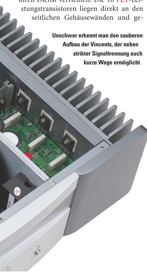
nißen dank der dort liegenden Kühlrippen eine optimale Wärmeabfuhr.
