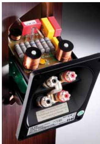
Das recht komplexe Netzwerk belegt zwei Platinen und sitzt direkt hinter dem Terminal.
